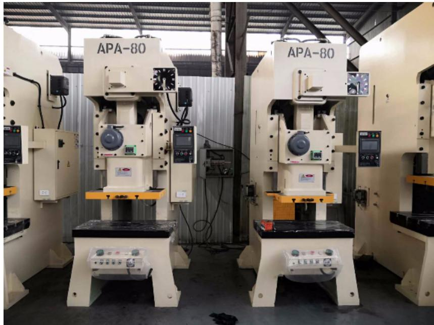
冲压生产主要是针对板材的。通过模具，能做出落料，冲孔，成型，拉深，修整，精冲，整形，铆接及挤压件等等，普遍应用于各个领域。如我们用的开关插座，杯子，碗柜，碟子，电脑机箱，甚至导弹飞机……有非常多的配件都可以用冲床通过模具生产出来。冲床的设计原理是将圆周运动转换为直线运动，由主电动机出力，带动飞轮，经离合器带动齿轮、曲轴（或偏心齿轮）、连杆等运转，来达成滑块的直线运动，从主电动机到连杆的运动为圆周运动！
