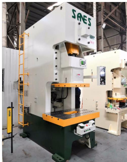
生产自动化、省力、效率高，冲床可搭配相应的自动送料装置，具有送料出错检测、预裁、预断装置，可完全实现自动化生产，成本低，效率高。滑块调整机构：滑快调整分为手动调整电动调整，方便可靠、安全、快捷，精度可达。设计新颖、环保。采用日本及先进技术以及设计理念，具有低噪音、低能耗、无污染的优点。按照驱动力不同分：滑块驱动力可分为机械式与液压式两种，故冲床依其使用之驱动力不同分为：机械式冲床(MechanicalPowerPress)□液压式冲床(HydraulicPress)□□
